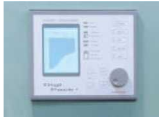
■ Parison Wall Thickness Controller, made in Japan by MOOG or YUKEN / Japonya'da MOOG veya YUKEN yapımı Et Kalınlığı Kontrolörü
