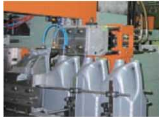
■ Auto Deflashing Device for Top and Bottom Deflashing, capable of getting rid of the overflow and flash around bottles and products / Otomatik Çapak Alma Cihazı ile Ürün etrafında, üstünde ve altındaki hammadde fazlalıklarını alır.
