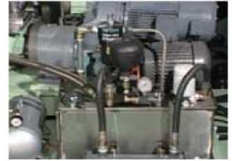
■ Independent Hydraulic System for the parison controller to ensure the quality performance of the precision servo circuit. / Hassas servo devresinin kalite performansını sağlayan, kalıp kontrolör için Bağımsız Hidrolik Sistem.
