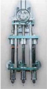
■ Pneumatic-driven Blowing System, which is capable of deflashing the bottle neck. The blow pin is circulated by chilled-water and guiding groove for forcing to guide and accurate bottle neck during calibrating./ Şişe boynunu açabilen Pnömatik Çalışan Şişirme Sistemi. Şişirme pimi, kalibrasyon sırasında yönlendirmeye ve doğru şişe boynuna zorlamak için soğutulmuş su ve suya yol veren oluk ile yönlendirilir.
